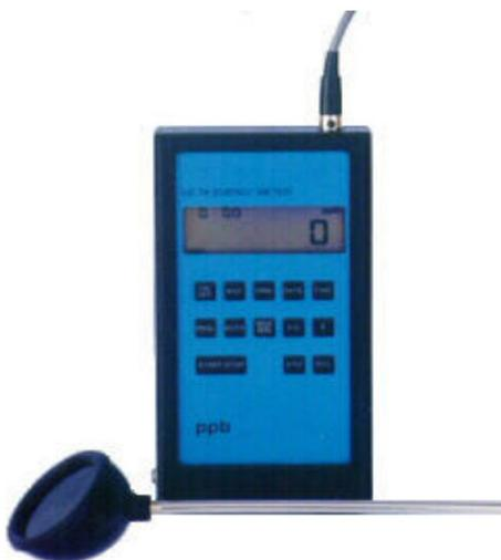
美国PPB超声波能量探测分析仪主要应用于超声波清洗设备清洗腔体内的超声波能量测试与分析，通过气穴碰撞原理，检测气穴密度，继而检测能量范围内超声波的频率和能量强度，也可以利用固定在腔体侧壁的探棒来测量超高音波的喷射流动能量。
